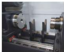
锥顶式夹装 Cone top clamp
