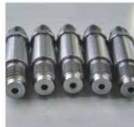
\Phi 3\text{mm} 不锈钢深孔加工 \Phi 3\text{mm} stainless steel Deep hole processing
